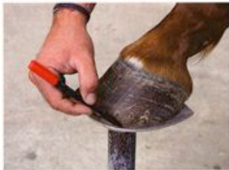
Il secondo passo consiste nel tracciare il perimetro del piede del cavallo sul ferro e tagliare via con un seghetto la parte che avanza.
