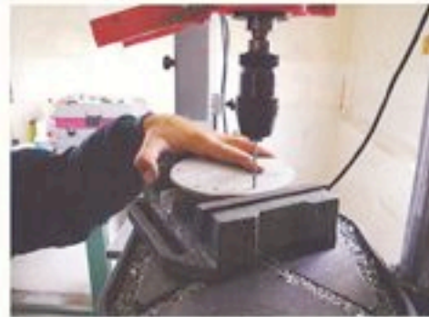
Dopo aver tagliato la parte di ferro in eccesso bisogna provvedere a preparare i buchi per i chiodi con cui il ferro verrà applicato al piede.
